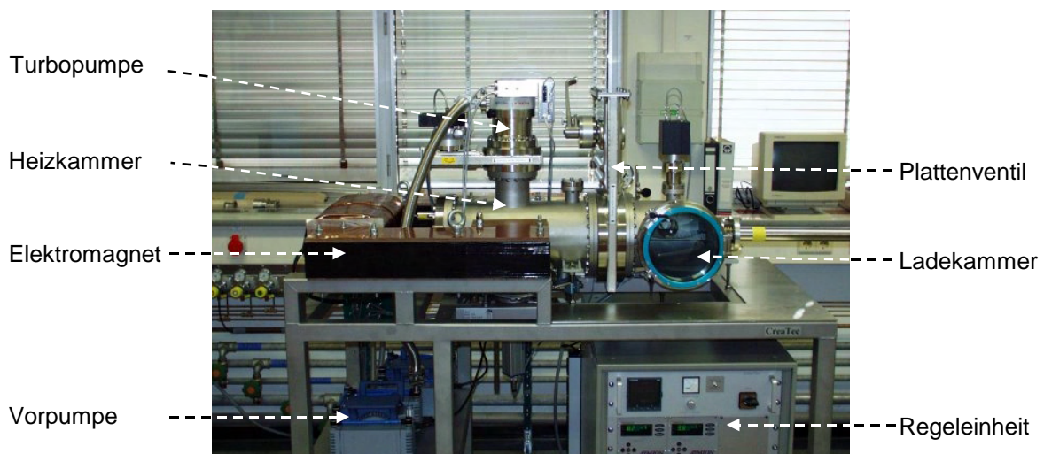
Abb. 3-4: Magnetfeldtemperofen mit den wichtigsten Bestandteilen.
