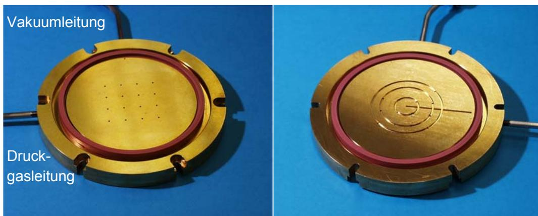
Abb. 3-13 Gegenwerkzeug zum Formwerkzeug aus Abb. 3-12 aus Messing mit Dichtung(en) aus Siliconkautschuk und mit 4 x 4 Löchern zur Beaufschlagung mit Druckgas im Raster von 10 x 10 mm in der Drauf- (links) und in der Untersicht (rechts) (Plattendurchmesser 116 mm)
