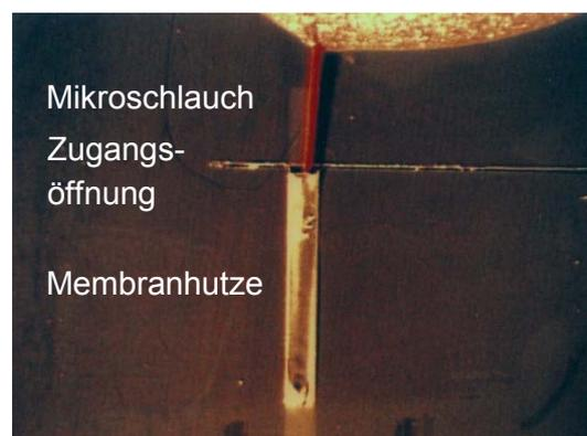
Abb. 2-7 PTFE-Membran und über einen Polyimidmikroschlauch ausgeführter Druckanschluss des Kanals aus Abb. 2-8
