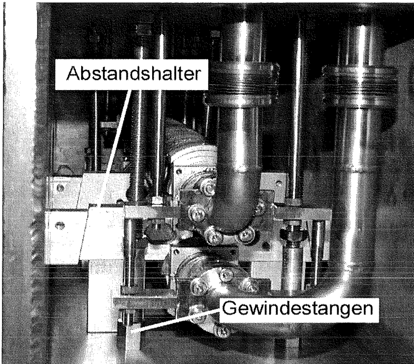
Abb. 5.10: Abstandshalter zur Fixierung der beiden Undulatorspulen und Gewindestangen zur Abstützung des Heliumbehälters.
