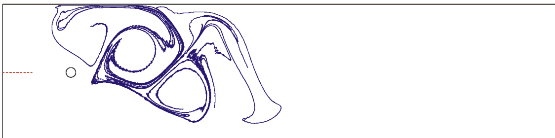
Abbildung 7.7: (a) Entwicklung der Länge eines Teils der Grenzflächen in der Zeit T für \Pi_y = 15 und \Pi_y = 30 , (b) markierter Teil der Grenzfläche zu Beginn ( T = 0\Delta t ) und zu einem späteren Zeitpunkt ( T = 190\Delta t ) für \Pi_y = 15 , (c) dto. für \Pi_y = 30 .
