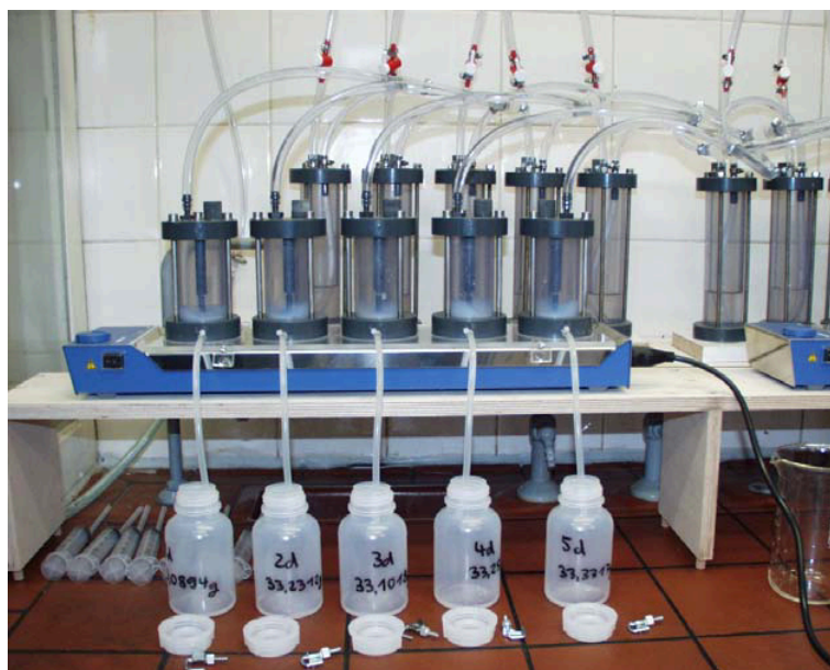
Abb. VI.3: Abbildung der linken Hälfte der Ultrafiltrationseinheit zur Entfernung von ungebundenem Protein bestehend aus zehn Ultrafiltrationszellen (vorne, vgl. Abb. VI.2) und zehn Vorratsgefäßen (dahinter). Das freie, nicht-adsorbierte Protein wird in Sammelgefäßen (unten) aufgefangen.
