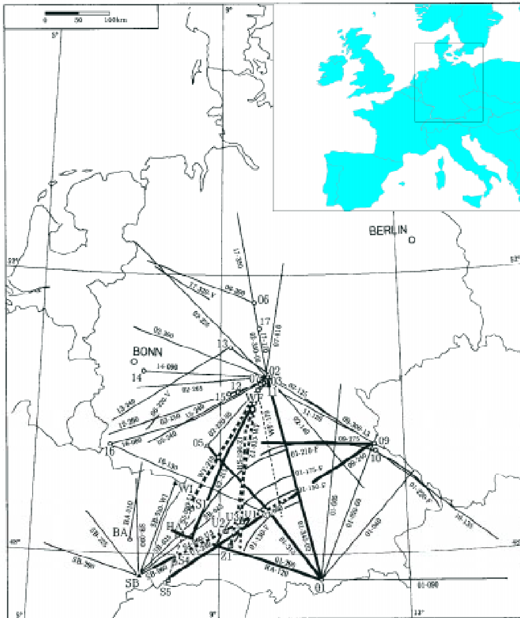
Abbildung 3.2: Refraktionsseismische Profile in Süddeutschland, die P_n -Daten liefern. Neuere Profile, die Bamford [1977] nicht zur Verfügung standen, sind gestrichelt dargestellt. Dicke Linien (durchgezogen oder gestrichelt) symbolisieren Profile, die zur Amplitudenauswertung benutzt wurden. Die Notation der Profilbezeichnung ist wie folgt: Schuß - Profilazimut - Gegenschuß (wenn vorhanden).
