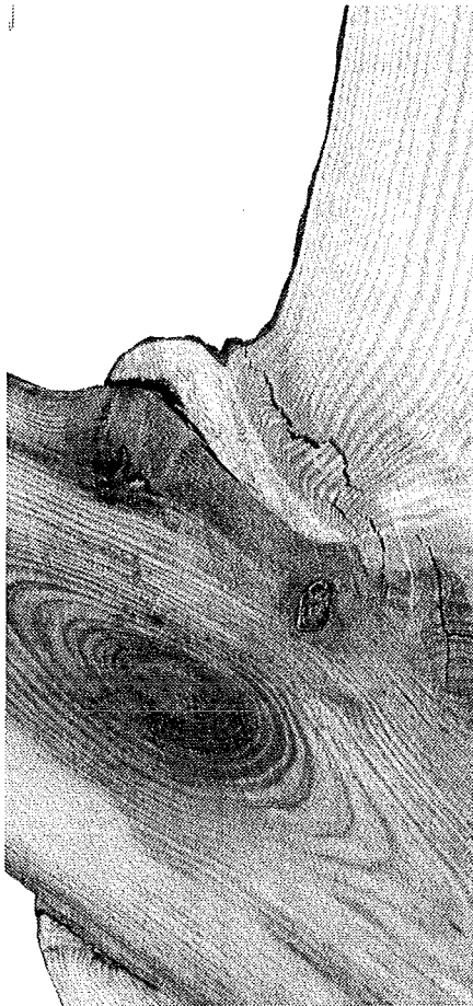
Abb. 4.30: Photographie eines Tangentialschnittes einer Kiefer ( Pinus Silvestris ).
