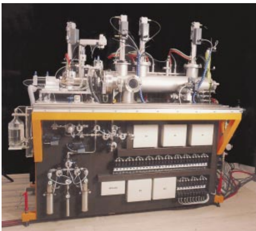
Abb. 2: Automatisiertes Hochstrom Xenon-Gastarget zur Erzeugung von isotopenreinem Jod-123.
