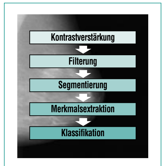
Abb. 3: Ablauf der Bildverarbeitung. Die digitalisierten Bilder werden zunächst durch Kontrastverstärkung und Unterdrückung von Bildfehlern qualitativ aufgebessert. Durch eine Filterung werden gezielt die gesuchten Strukturen hervorgehoben und gleichzeitig der Hintergrund unterdrückt. Danach werden die gesuchten Strukturen durch Schwellwerte vom Hintergrund getrennt (Segmentierung). Die gefundenen Strukturen werden analysiert und ihre speziellen Eigenschaften extrahiert. Diese Eigenschaften dienen der abschließenden Klassifikation als Entscheidungsbasis, ob ein Bild einer bestimmten Gruppe zugehörig ist. Im Beispiel der Mammografie wird entschieden, ob ein Mammogramm krebserdächtige Strukturen enthält oder nicht.
