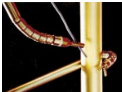
Abb. 2 zeigt als Beispiel ein flexibles Instrument, mit dessen steuerbarem vorderem Ende die Umfahrung von Organen möglich ist.
