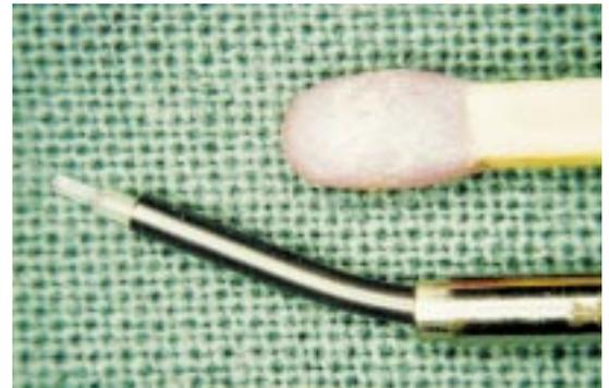
**Abb. 10: Stufenlos deflektierbarer Laserapplikator auf der Basis eines NiTi-Röhrchens. Die durchgeführte Laserfaser ist 400  $\mu\text{m}$  dünn und kann während einer endoskopischen Operation optimal auf das Zielgebiet ausgerichtet werden (mit freundlicher Genehmigung der Aesculap AG, Tuttlingen).**
