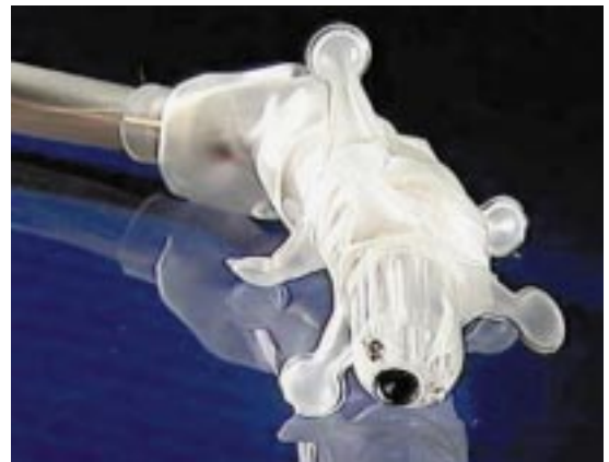
Abb. 7: Das Koloskop kann sich aus eigenem Antrieb im Darm fortbewegen.
