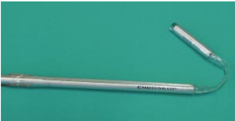
Abb. 6: Im Endoskopiekamera-Aufnahmesystem arbeiten die neuen Aktoren auch nach dem Kontraktionsprinzip.
