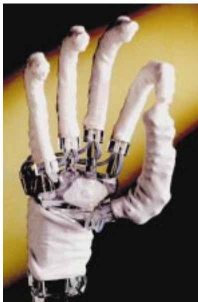
Abb. 4: Die künstliche Hand auf der Basis flexibler Fluidaktoren kommt dem natürlichen Original nahe.
