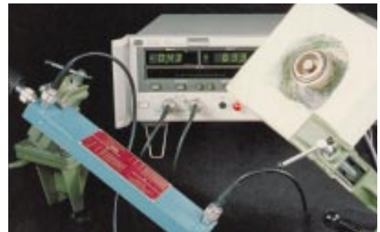
Abb. 3: Messplatz zur Bestimmung von dielektrischen Materialeigenschaften.
