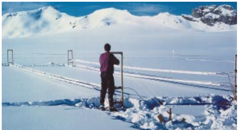
Abb. 8: Ansicht der Schneefeuchtemesskabel kurz nach dem Aufbau (Plaine-Morte-Gletscher, Schweiz). Durch die winterlichen Schneefälle werden die Kabel vollständig eingeschneit.
