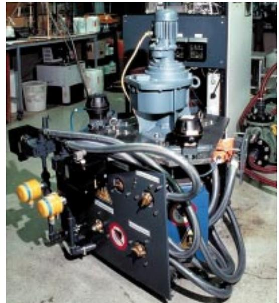
Abb. 3: Seitenansicht des auf Permanentmagneten basierenden Karussell-Magnetseparators KMP3.
