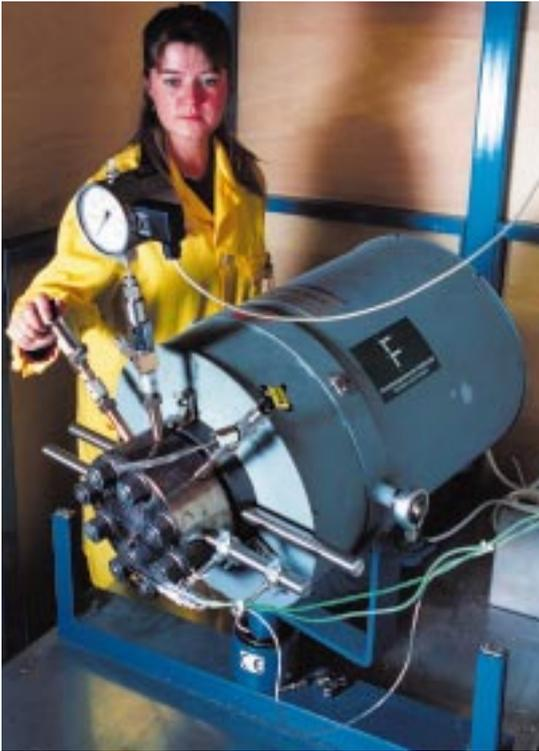
Abb. 4: Taumelautoklav (1 l Innenvolumen, bis 500 bar und 500°C).
