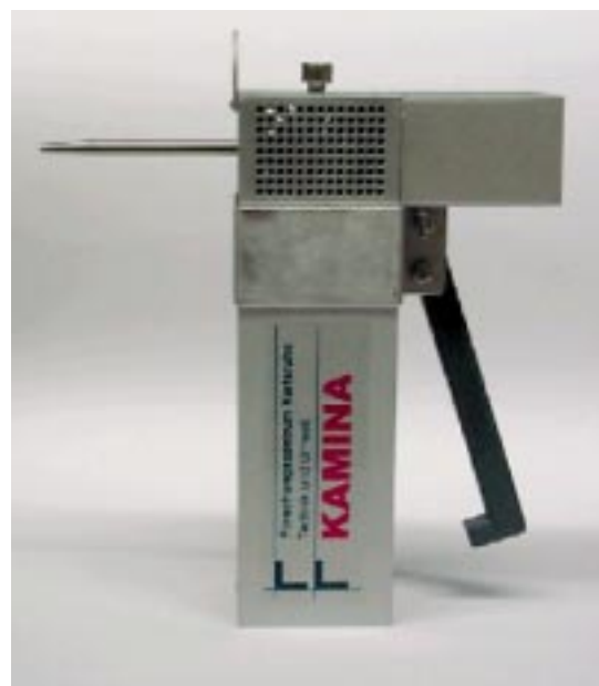
Abb. 4: KAMINA-Betriebsgerät mit Ansaugkanüle und Mikropumpe (im Gehäuse).
