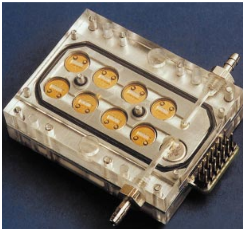
Abb. 2: SAW-Sensorarray im Demonstrationsgehäuse aus Plexiglas. Der Sensorkopf mit den Abmessungen 60×46×17 mm 3 enthält 8 einzeln auswechselbare SAW-Sensoren.
