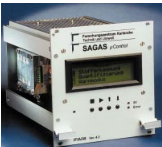
Abb. 4: Das komplette SAW-Sensorsystem, das vom PC oder mit Hilfe eines Mikroprozessors gesteuert werden kann. Die Musteranalyse kann auch im Gerät selbst vorgenommen und das Ergebnis über ein Display zur Anzeige gebracht werden.
