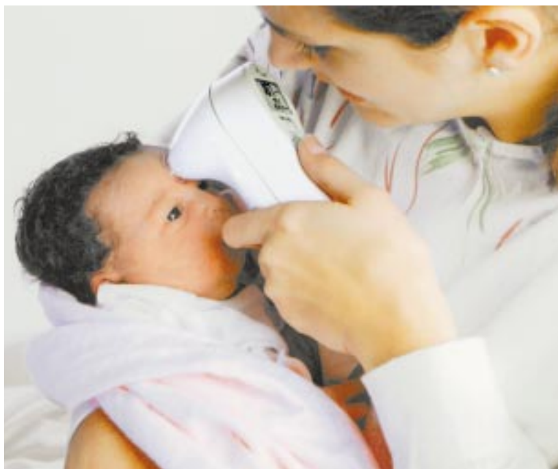
Abb. 9: Messgerät für Neugeborenenengelbsucht auf der Basis eines Mikrospektrometers.
