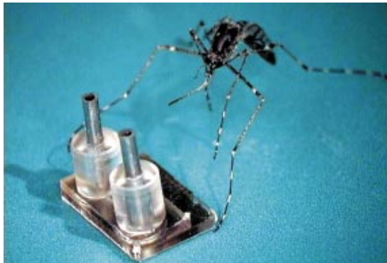
Abb. 2: Mit dem AMANDA-Verfahren hergestellter anemometrischer Fluss-Sensor. Die Wärmeableitung durch das umgebende Medium von einer dünnen Leiterbahn im Inneren einer nur 2,4 \mu\text{m} dicken Polyimidmembran dient als Maß für die Strömungsgeschwindigkeit
