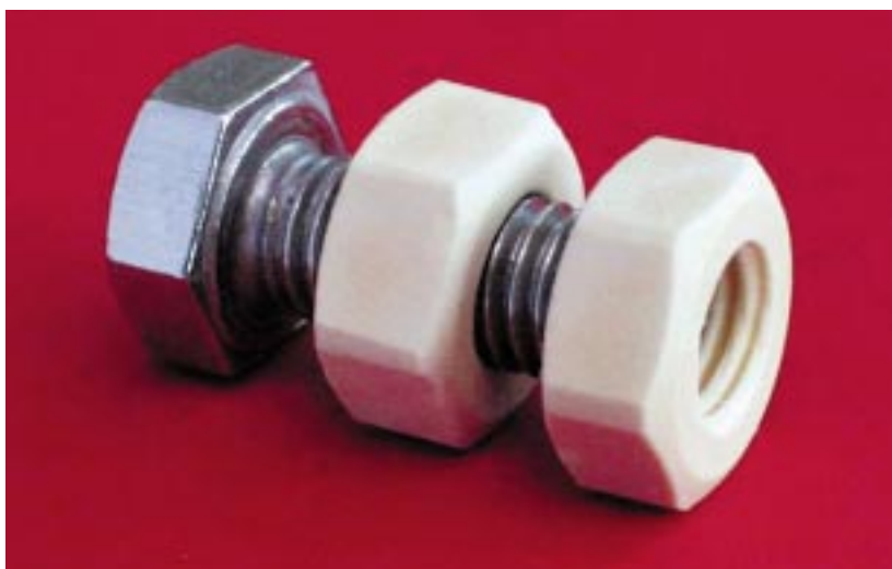
Abb. 4: Stahl-Sechskantschraube M8 x 20 DIN 933 mit passgenauen keramischen Sechskantmutter M8 DIN 934 aus schwindungsfreier Keramik, im Grünzustand spanabhebend gefertigt.
