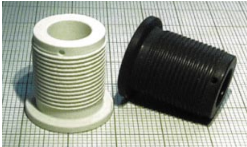
Abb. 1: Durch Mikrofräsen abgeformtes Keramikteil als Grünkörper (rechts) und als gesintertes Teil (links). (Die Formgebung durch Mikrofräsen wurde im Institut für Mikroverfahrenstechnik des FZK durchgeführt).
