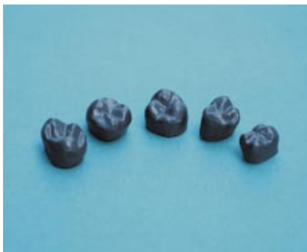
Abb. 6: Gefräste, passgenaue Dentalkronen vor dem Reaktionssintern (links) und danach (rechts).
