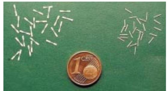
**Abb. 3:** Prüfkörper mit minimalem Querschnitt von 200 µm x 200 µm für Mikro-Zug- (links) und -Biege-Versuche (rechts), hergestellt durch Hochdruck-Keramik-Spritzgießen (HP-CIM) aus ZrO<sub>2</sub>-Keramik.
