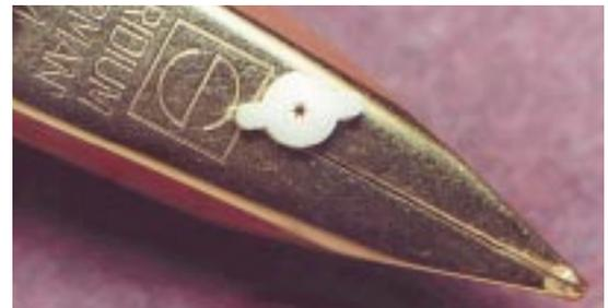
**Abb. 4:** Mikro-Zahnrad-Form aus ZrO<sub>2</sub>-Keramik, 500 µm hoch, hergestellt durch Hochdruck-Keramik-Spritzgießen (HP-CIM): der Zahnkopfdurchmesser beträgt 480 µm, die minimale Zahnbreite ca. 70 µm.
