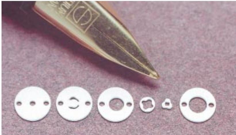
**Abb. 4: Komponenten einer Mikro-Zahnringpumpe aus Oxidkeramik mit minimalen Wandstärken von 100  $\mu\text{m}$  und einer Strukturhöhe von 300  $\mu\text{m}$ .**
