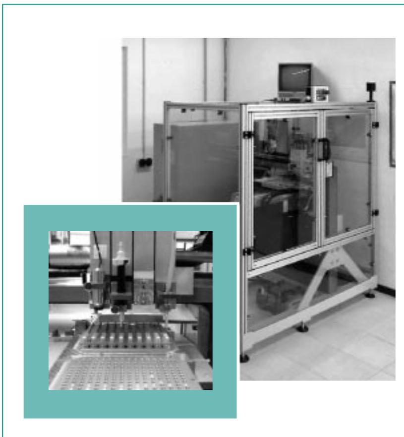
**Abb. 5: Realisierte Maschine zur Montage von mikrofluidischen Analysesystemen.**
