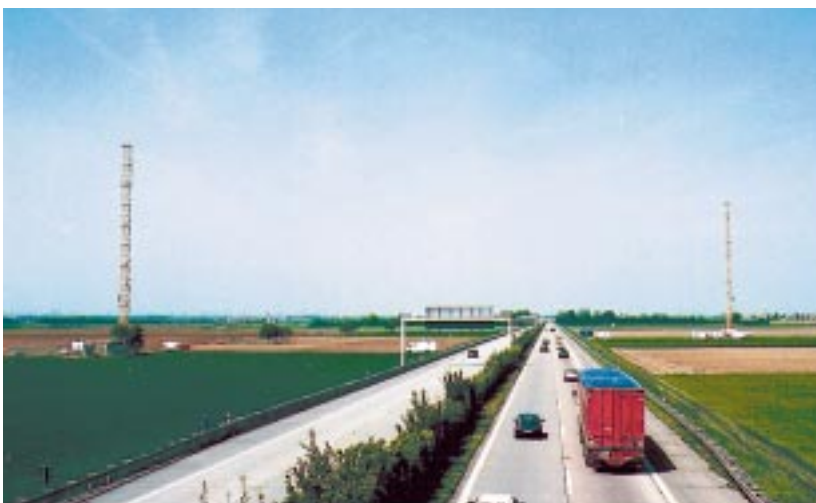
Abb. 1: Übersicht über das Messfeld an der Autobahn 656 bei Heidelberg-Wieblingen. Zur Erfassung der Vertikalprofile sind rechts und links 52 m hohe Krantürme aufgestellt worden.
