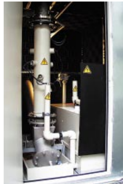
Abb. 3: Die mobile Karlsruher Elektroporations-Anlage KEA. Links eine Gesamtansicht der Anlage. Rechts das Prozessgefäß mit den in die Wand eingelassenen 4 Elektrodenpaaren aus Edelstahl. Bei nominaler Pulsspannung erreicht das Feld zwischen den Elektroden 12 kV/cm. Die elektrischen Impulse werden mit einer Frequenz von bis zu 10 Hz, mit einer Amplitude von 300 kV und einer Dauer von \sim 1 \mu s mit Hilfe eines sechsstufigen Marxgenerators erzeugt. Die Rüben durchfallen das Rohr von oben nach unten in einem Wasserbad und verlassen es mit Hilfe eines Schneckenförderers.
