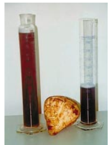
Abb. 4: Links: Konsistenz einer Zuckerrübe rechts vor und links nach Elektroporation. Safttropfen auf der linken Schnittfläche der behandelten Rübe sind ein Indikator für die Zerstörung der Zellmembranen. Rechts: Saftausbeute nach Elektroporation und 15-minütigem Kaltpressen mit 32 bar (links), Saftausbeute nach klassischer Behandlung (rechts).
