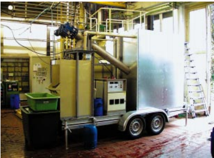
Abb. 3: Die mobile Karlsruher Elektroporations-Anlage KEA. Links eine Gesamtansicht der Anlage. Rechts das Prozessgefäß mit den in die Wand eingelassenen 4 Elektrodenpaaren aus Edelstahl. Bei nominaler Pulsspannung erreicht das Feld zwischen den Elektroden 12 kV/cm. Die elektrischen Impulse werden mit einer Frequenz von bis zu 10 Hz, mit einer Amplitude von 300 kV und einer Dauer von \sim 1 \mu s mit Hilfe eines sechsstufigen Marxgenerators erzeugt. Die Rüben durchfallen das Rohr von oben nach unten in einem Wasserbad und verlassen es mit Hilfe eines Schneckenförderers.
