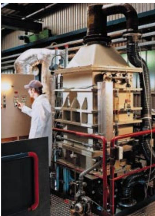
Abb. 4: CAROLA Abscheider für Verbrennungsanlagen (Durchsatz  $2500 \text{ m}^3/\text{h}$ ).
