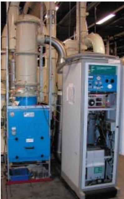
**Abb. 5: CAROLA-System zur Abscheidung von Kühlschmierstoffnebeln (links) und Partikelmesstechnik (rechts) beim Einsatz in der Automobilindustrie. Im blauen Metallgehäuse ist ein Vorabscheider für grobe Öltröpfchen und ein Gebläse eingebaut. Dieses fördert das zureinigende Gas in die darüber installierte CAROLA-Stufe. Nach Passieren des Rohrpakets, wird das gereinigte Gas über das Metallrohr an der rechten oberen Seite des Abscheiders abgeleitet.**
