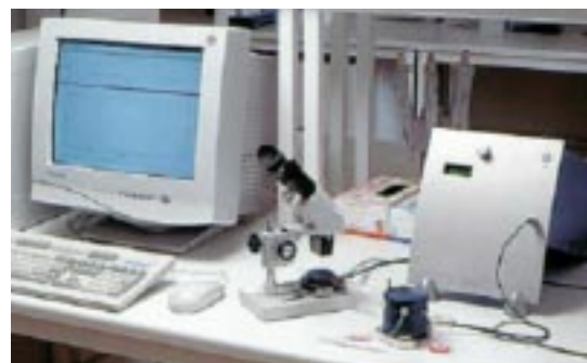
Abb. 2: QCM-D Messaufbau. Rechts Hochfrequenzelektronik, davor Messkammer für Durchflussmessungen, am Binokular zweite Messkammer mit Sichtfenster.
