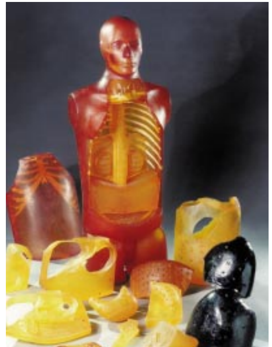
Abb. 3: Physikalisches Phantom zur Kalibrierung von Ganz- und Teilkörperzählern für Nukliddepositionen in den wichtigsten Organen und Gewebestrukturen des Körpers.
