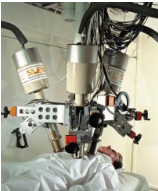
Abb. 2: Teilkörperzähler mit vier HPGe-Sandwich-Detektoren zur Messung von Photonenstrahlen im Energiebereich von 15 bis 200 keV in der Lunge.
