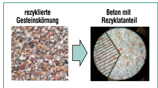
Abb. 1: Verwendung eines Anteils rezyklierter Gesteinskörnung für Beton (schematisch).
