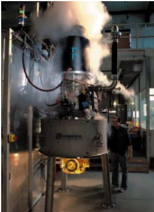
Abb. 3: Foto des TE_{28,8} -Gyrotrons für W7-X im Teststand des Forschungszentrums.
