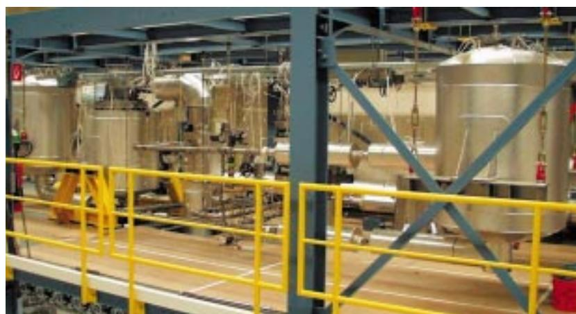
Abb. 4: THEADES-Teststrecke des KALLA-Labors zur Untersuchung thermo-hydraulischer Fragestellungen in Blei-Wismuth.
