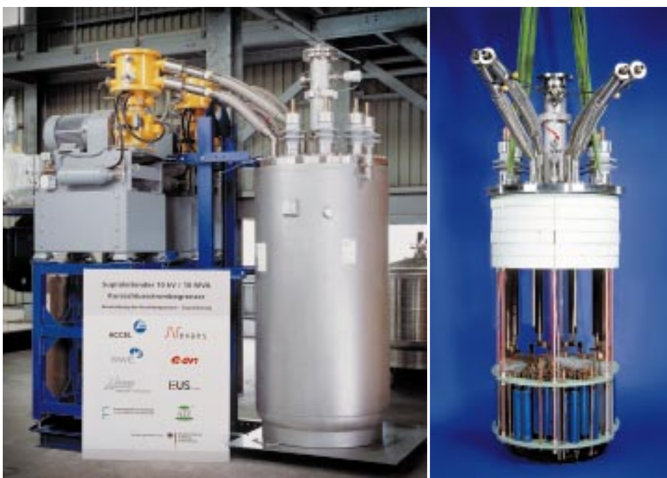
Abb. 1: Aufbau eines 10 MVA, 10 kV supraleitenden Strombegrenzers.
