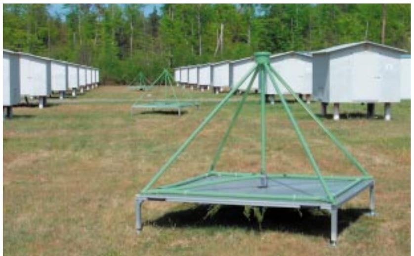
**Abb. 1:** Teilchendetektoren des KASCADE-Grande-Experiments und Radioantennen des LOPES-Projekts sind integriert, um galaktische kosmische Strahlung zu studieren und neue Technologien zu entwickeln.
