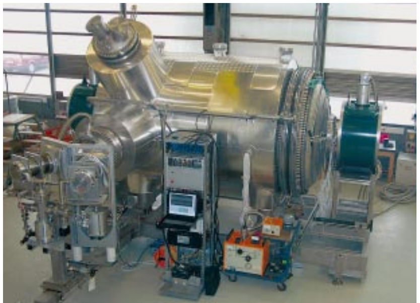
Abb. 2: Das Vorspektrometer sortiert die Elektronen geringer Energie aus, die keine relevanten Informationen tragen.
