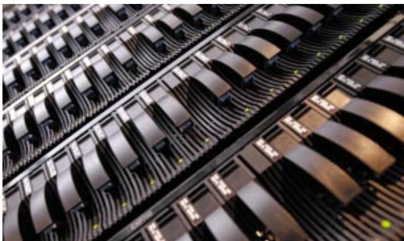
Abb. 2 : Festplattensysteme mit mehr als 4.000 Platten und einer Speicherkapazität von insgesamt knapp 800 Terabyte: Das entspricht rund 10.000 Arbeitsplatz-PCs und ist zur Zeit die größte Ansammlung von Plattenspeichersystemen in der deutschen Wissenschaftslandschaft.
