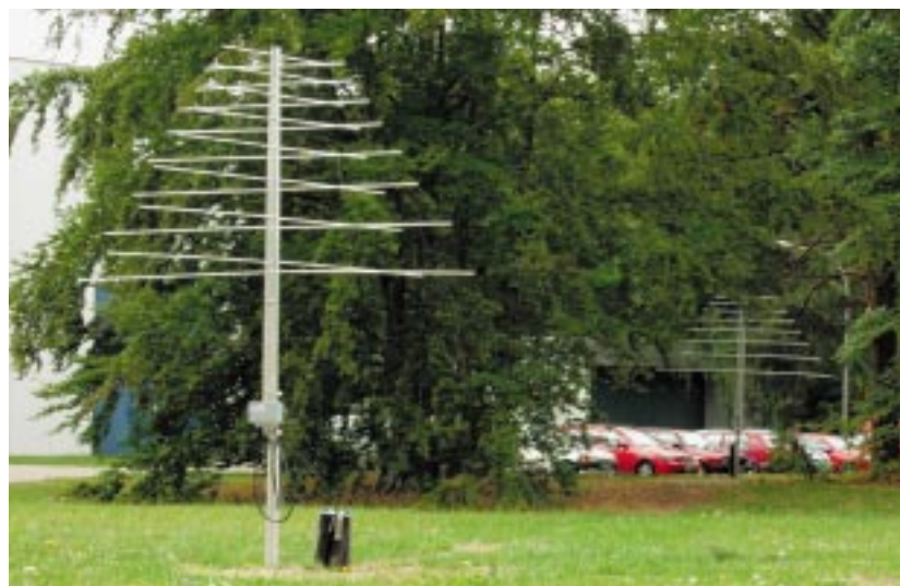
Abb. 8: Kreuzpolarisierte logarithmisch-periodische Dipolantennen der LOPES STAR -Empfängerstationen.
