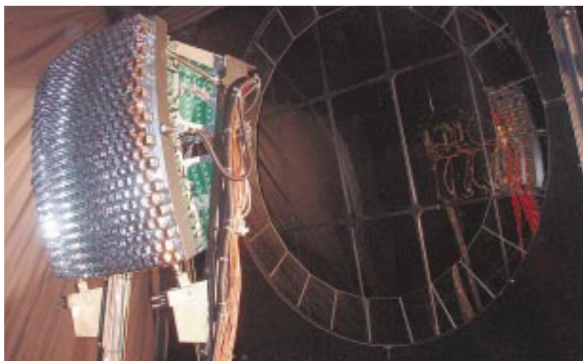
Abb. 4: Blick auf eine Pixelkamera mit 440 PMTs und die ringförmige Korrekturlinse. Die Rückseite der Kamera spiegelt sich in der UV-Filterscheibe.
