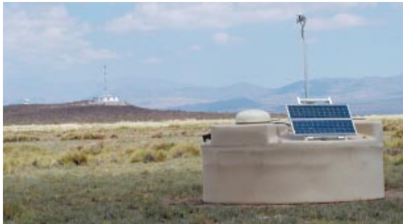
Abb. 3: Ein mit zwölf Tonnen ultrareinem Wasser gefüllter Detektor-tank. Im Hintergrund auf dem Hügel das erste Teleskopgebäude „Los Leones“.
