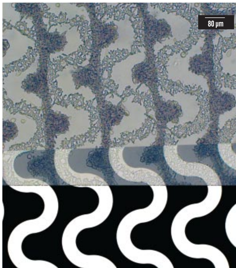
Abb. 4: Fotomontage. Oben: Durch UV-Bestrahlung modifizierte Schicht aus PPC-Nanofasern auf einem Deckgläschen. Mitte und unten: Die verwendete Lithographiemaske im gleichen Maßstab.
