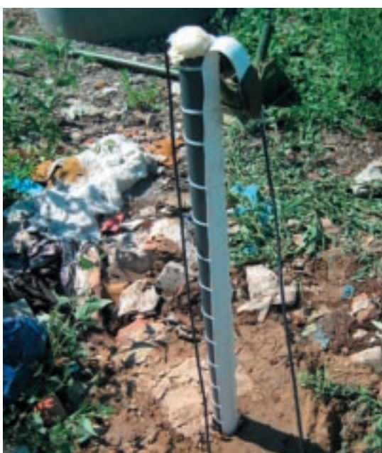
Abb. 6: Rohrsensor für Vertikalprofil der Feuchte in einer Mülldeponie.
