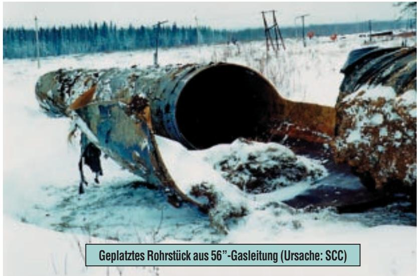
**Abb. 1: Beispiel für einen Pipelineschaden, der durch Spannungsrisskorrosion verursacht wurde.**
