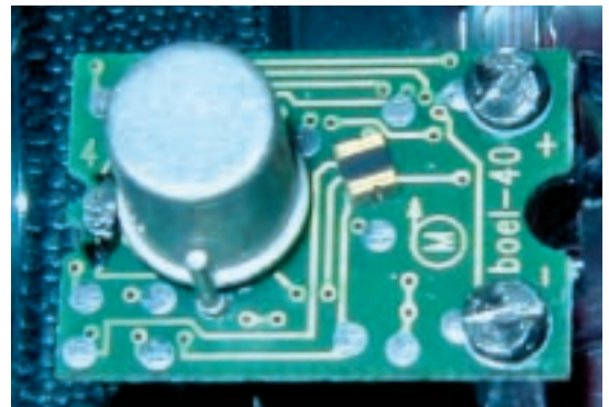
Abb 2: Größenvergleich zwischen einem herkömmlichen Kugelschalter und dem Mikro-Vibrationssensor von Sensolute.
