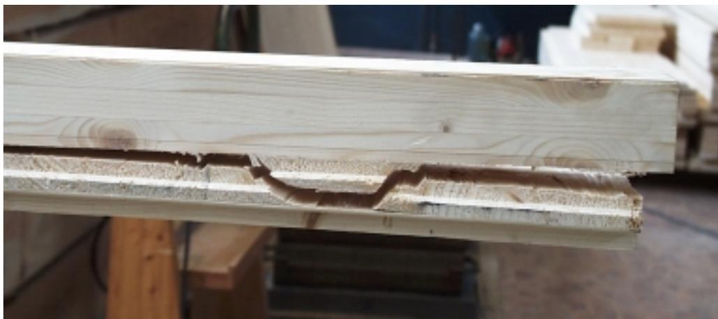
**Bild 17:** Schubversagen zwischen der Querlage und dem Steg (Rollschub)
