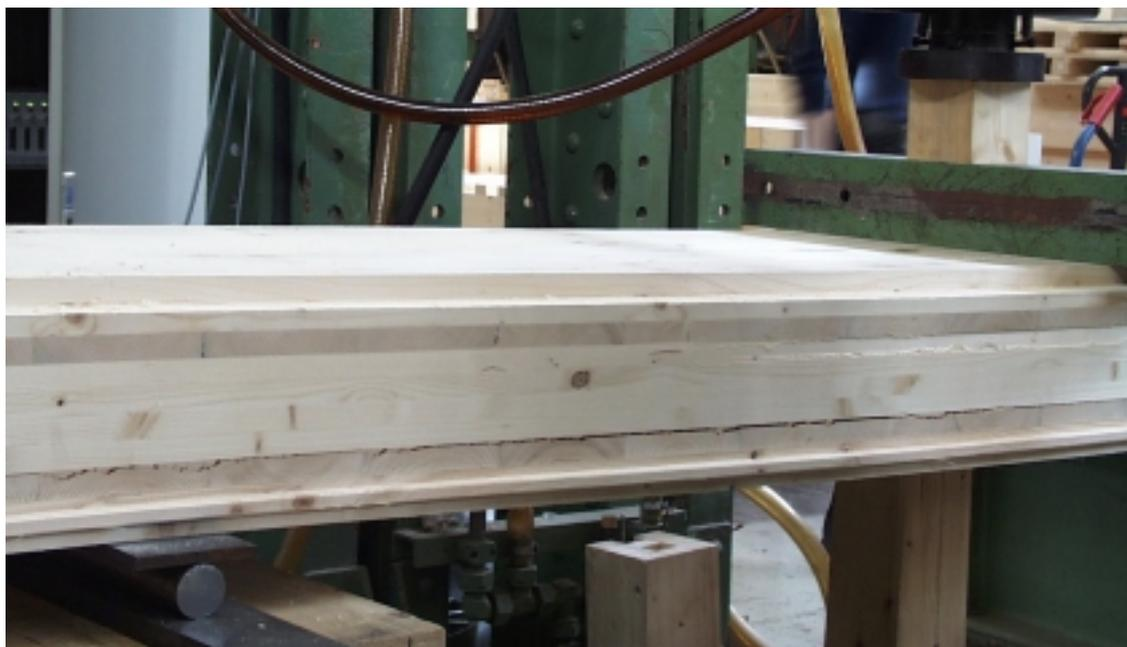
**Bild 14:** Schubversagen zwischen der Querlage und den Stegen (Rollschub)
