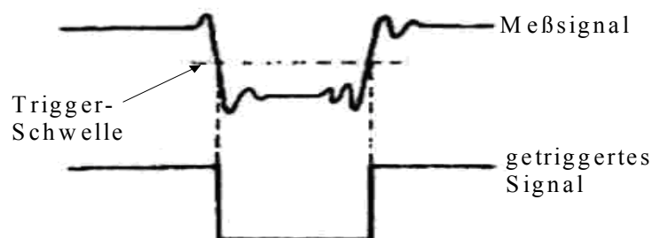
Abb. 4.15: Einstellung der Triggerschwelle (Aufderheide et al., 1983)
