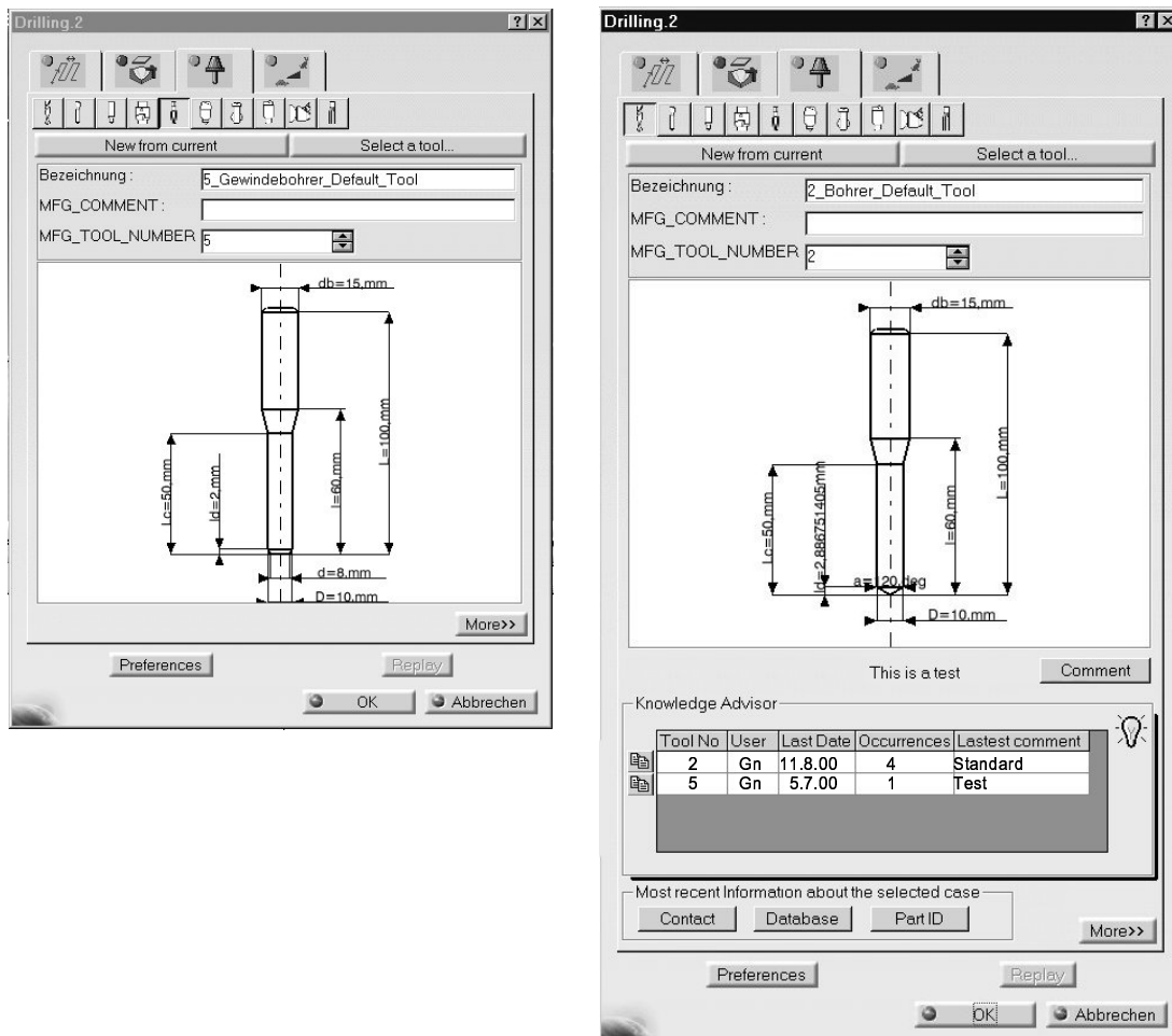
Bild 5-5: Vergleich zwischen dem Standarddialog in CATIA V5 und der Unterstützung mit dem Assistenzsystem
