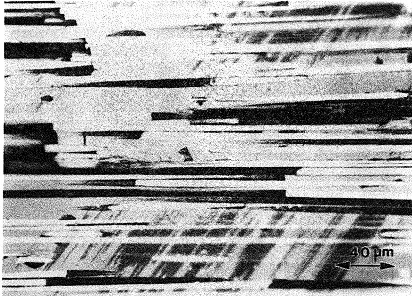
Abb. 56: Mikrorisse in der gleichen Probe wie oben (Abb. 55), bei einer Belastung von 600MPa
