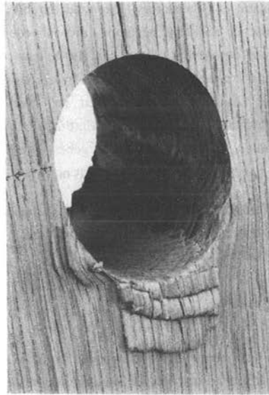
Bild 2.1.11: Verformung des Holzes unter Lochleibungsbeanspruchung
