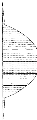
Bild C-5: Schubspannungsverlauf \tau nach Schubanalogie
