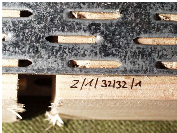
Bild 3: Große Lochleibungsverformungen bei der Feuchtekombination (32%, 32%) und Winkelkombination (0°, 0°)
