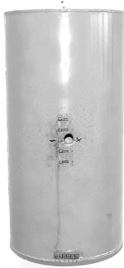
Abb. 5.36 Einschussseite des leeren Behälters Beh.6 ( v_0 = 721 \text{ m/s} )
