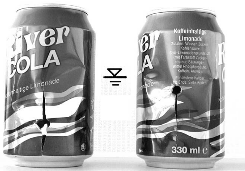
Abb. 4.13 Zur Hälfte mit Flüssigkeit gefüllte Dosen. Links erfolgte der Beschuss unterhalb der Flüssigkeitsoberfläche (Getränkedose (9)) und rechts auf der Höhe der Flüssigkeitsoberfläche (Getränkedose (8))
