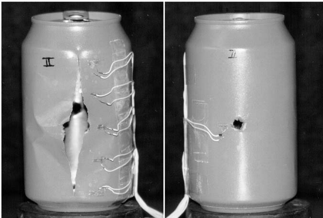
Abb. 4.16 Vorder- und Rückansicht der Dose II nach dem Beschuss
