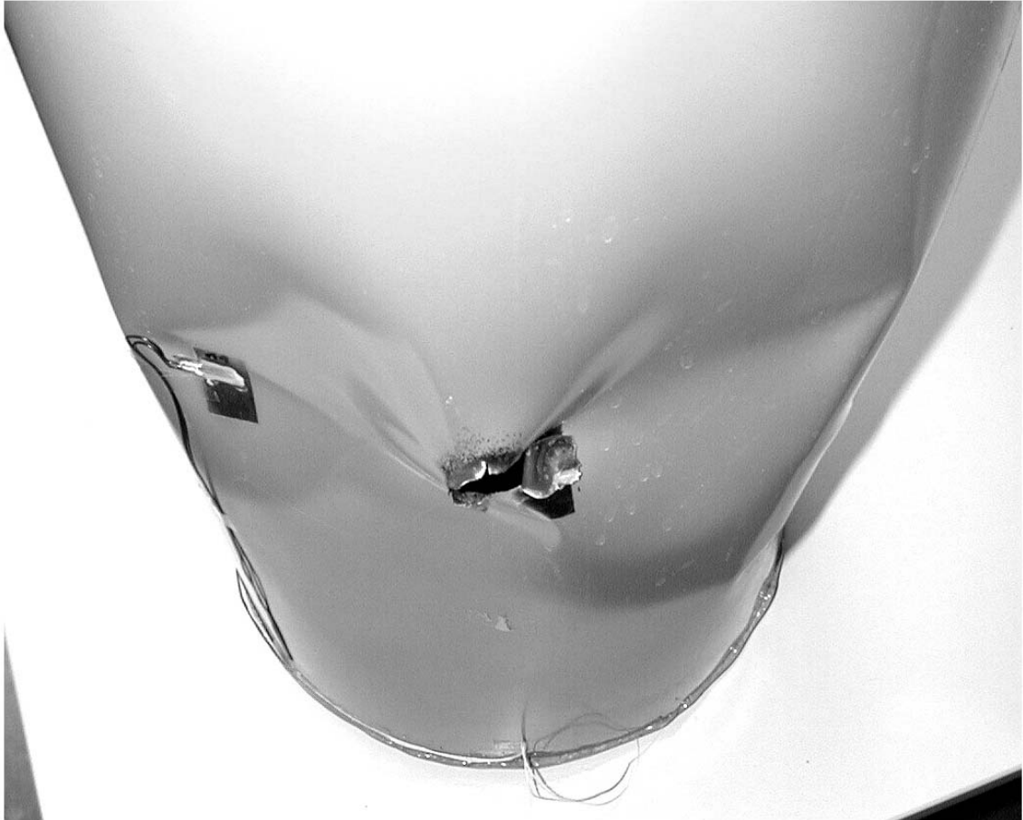
Abb. 5.18 Behälterrückseite von Beh.4 mit dem Ausschuss des Projektils und der rechts und links nach innen eingedrückten Behälterwand
