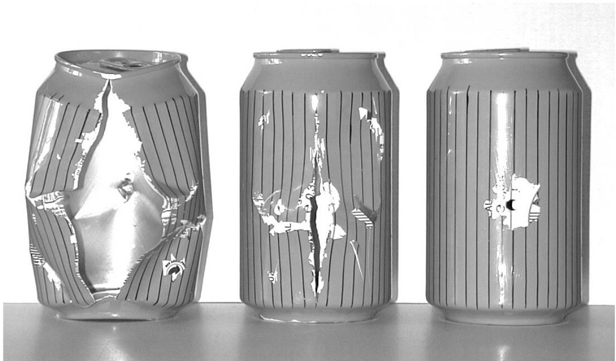
Abb. 4.12 Vollständig mit Flüssigkeit gefüllte Dosen. Links mit anfänglichen statischen Innendruck (Dose E), in der Mitte (Dose F) und rechts (Dose C) ohne Innendruck
