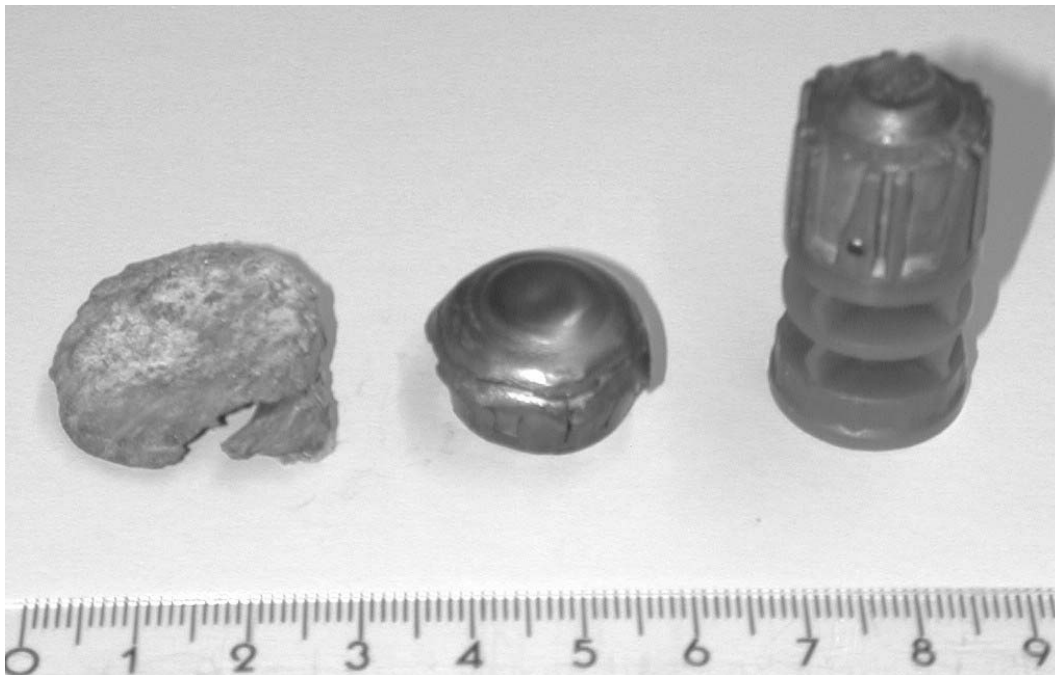
Abb. 5.3 KO-Flintenlaufgeschoss nach dem Beschuss eines leeren Behälters, eines vollen Behälters und undeformiert
