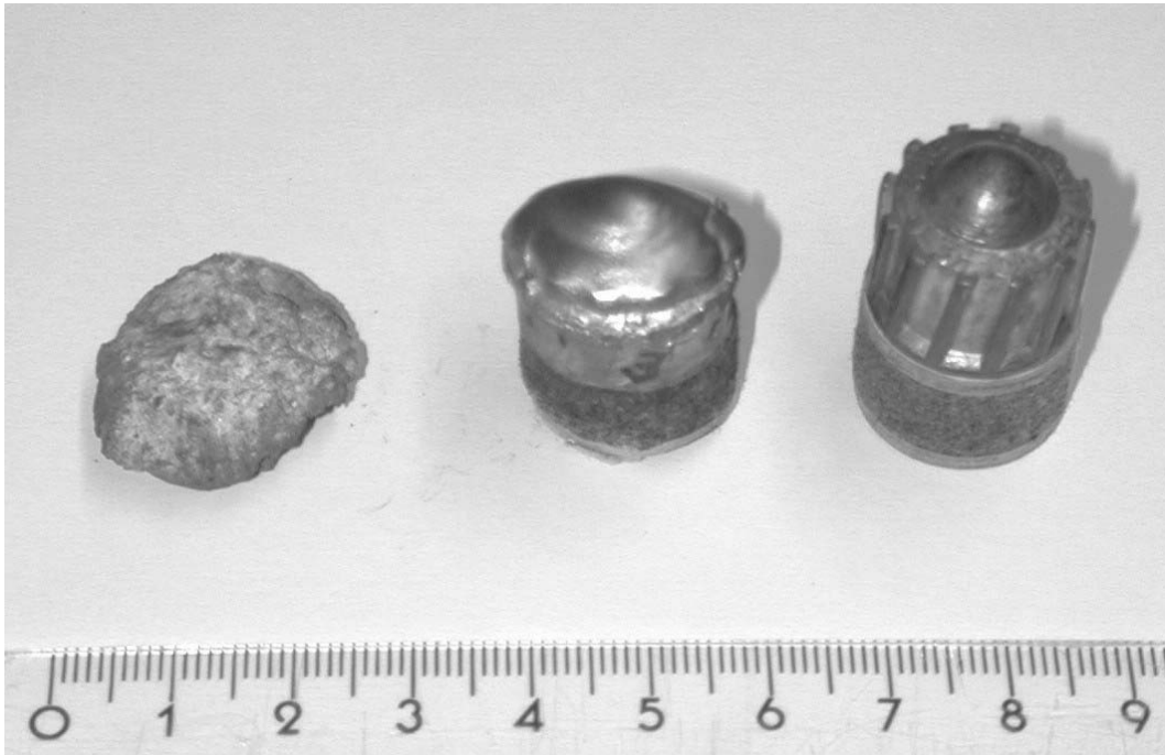
Abb. 5.4 Brenneke-Flintenlaufgeschoss nach Beschuss eines leeren Behälters, eines vollen Behälters und undeformiert
