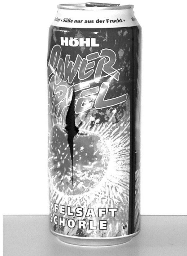
Abb. 4.15 Vollständig mit Wasser gefüllte und offene 0,5 Liter Getränkedose (M)
