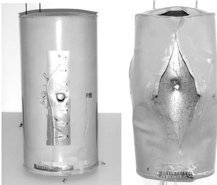
Abb. 5.26 Vorderansicht auf die Behälter Beh.2 und Beh.5 mit je 1,0 mm Wandstärke nach dem Beschuss
