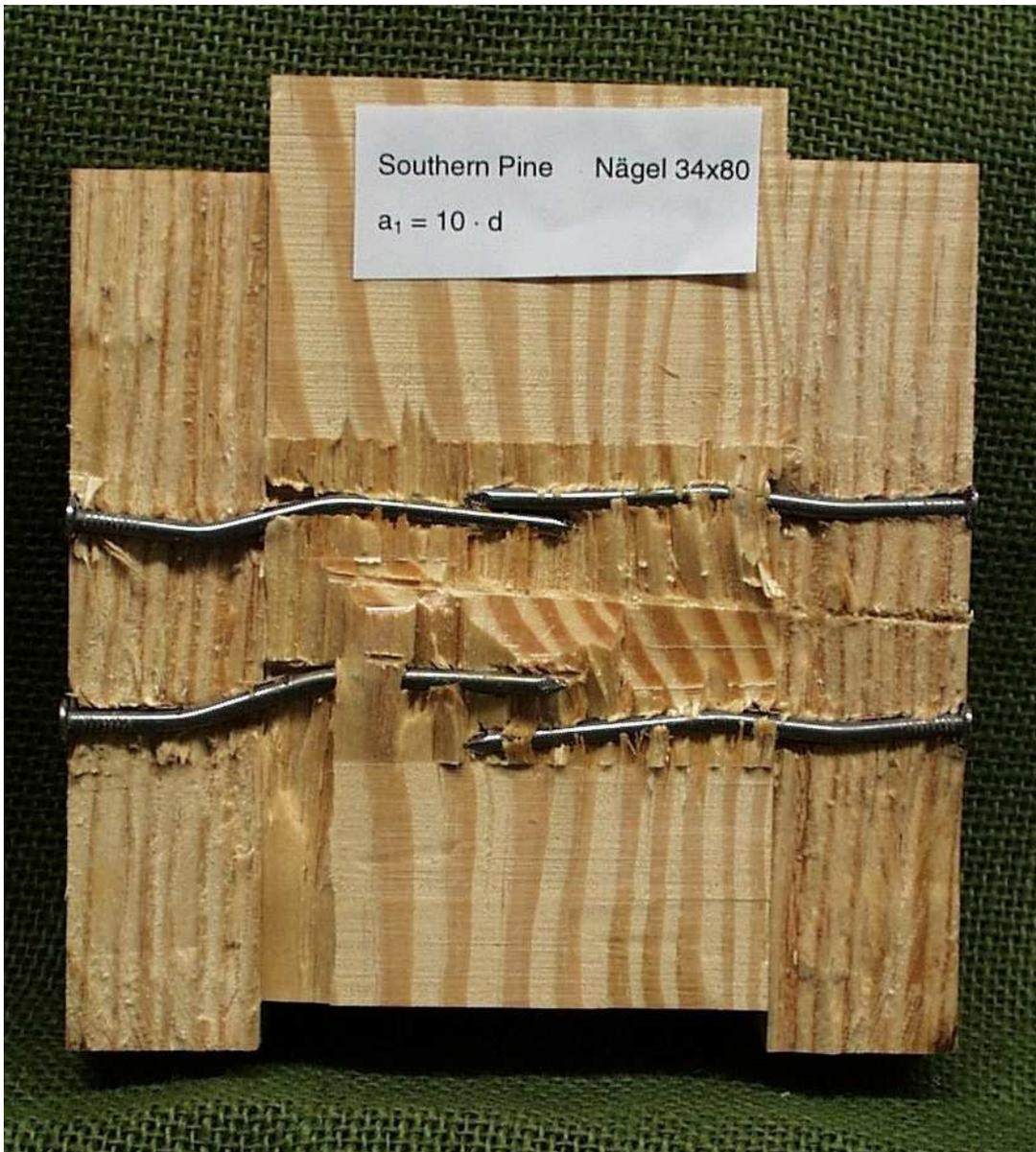
**Bild 8.2.12:** Geöffneter Anschlussbereich eines Prüfkörpers aus southern pine
