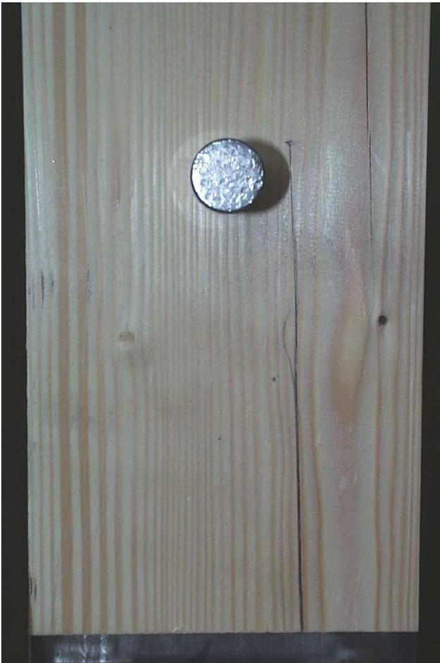
**Bild 6.2.2:** Schwindriss bei Prüfkörper Ta\_10\_9d
