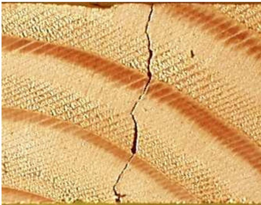
**Bild 5.3.13:** Verlauf der Rissfront in einem Douglasienprüfkörper
