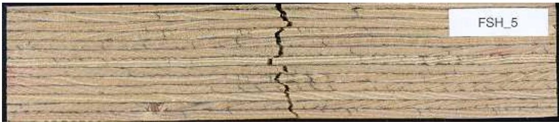
**Bild 5.3.14:** Verlauf der Rissfront in einem Prüfkörper aus FSH
