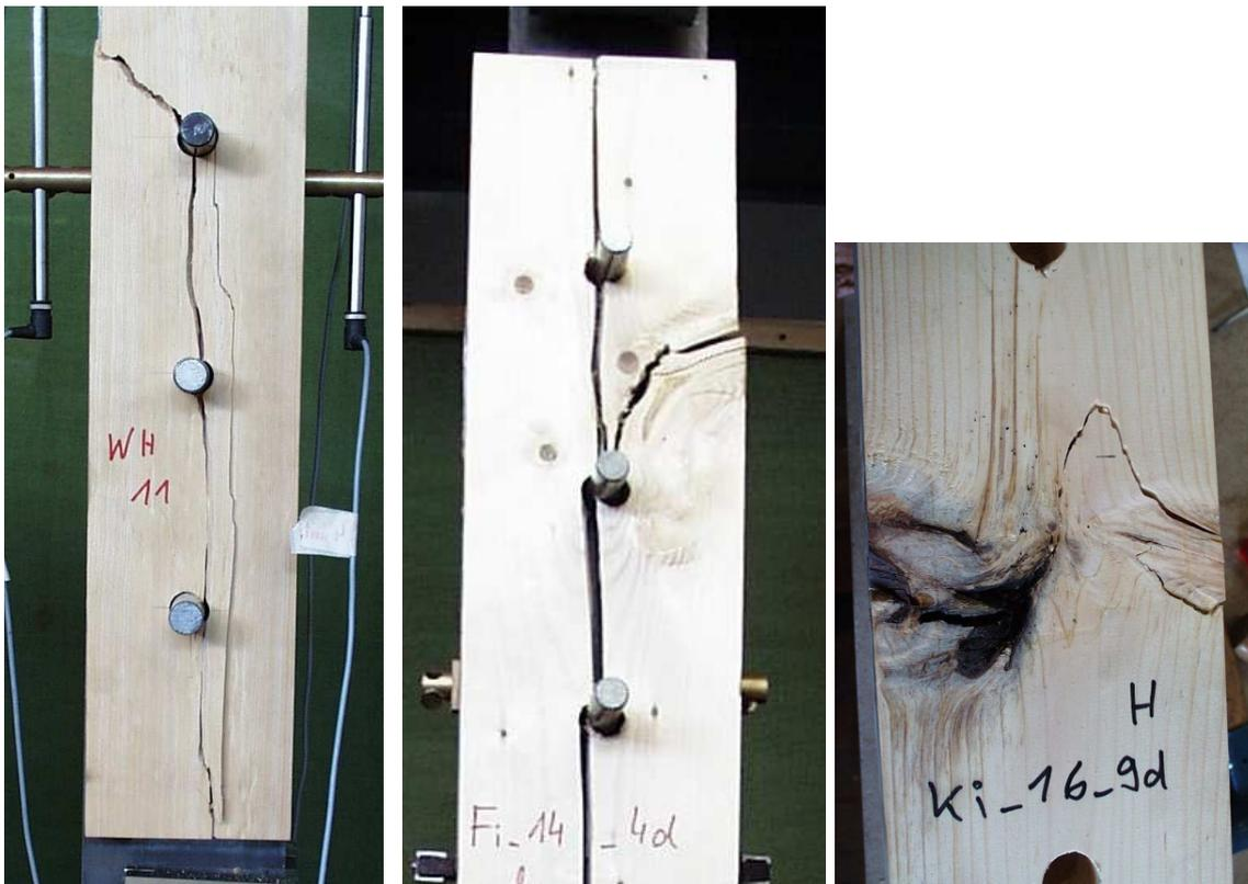
**Bild 6.2.1:** Zugbrüche teilweise mit Rissen parallel zur Faserrichtung
