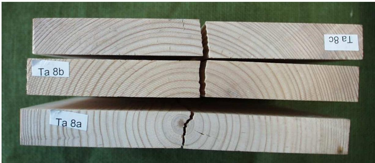
**Bild 5.2.6:** Ansicht der Schmalseite von Tannenprüfkörper nach dem Versuch
