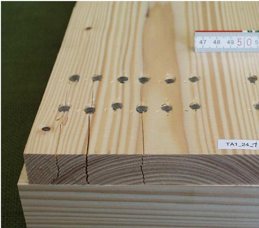
**Bild 4.2.6:** Spalten durch Einschlagen von Drahtstiften
