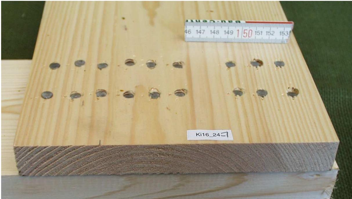
**Bild 7.2.4:** Prüfkörper aus Kiefernholz der Serie 7.2
