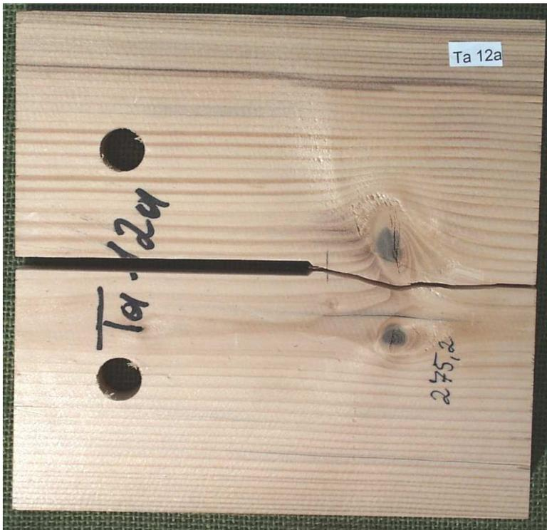
**Bild 5.3.2:** Prüfkörper mit Einfluss des Astes auf das Risswachstum
