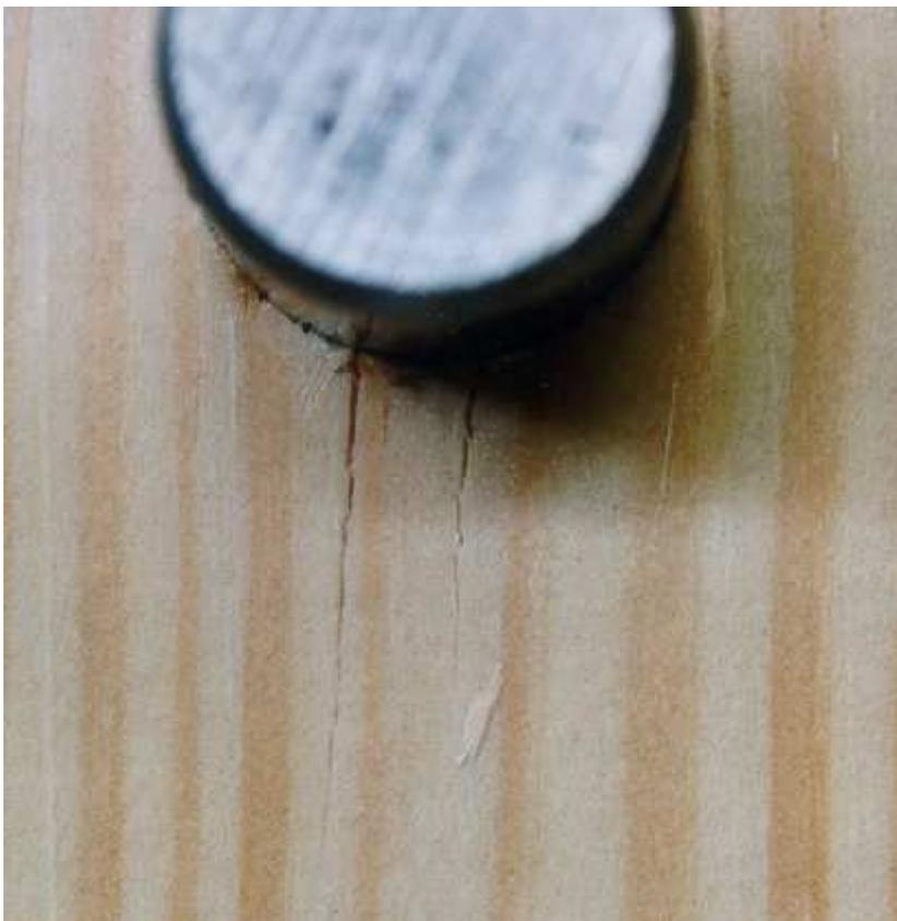
**Bild 4.2.4:** Zwei Risse an einem Prüfkörper nach Abschnitt 6
