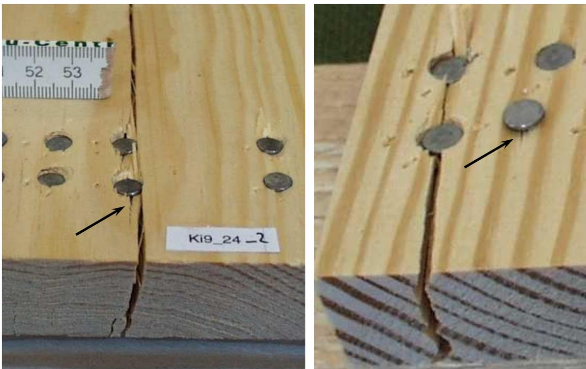
**Bild 7.1.1:** Risse bei Einschlagversuchen
