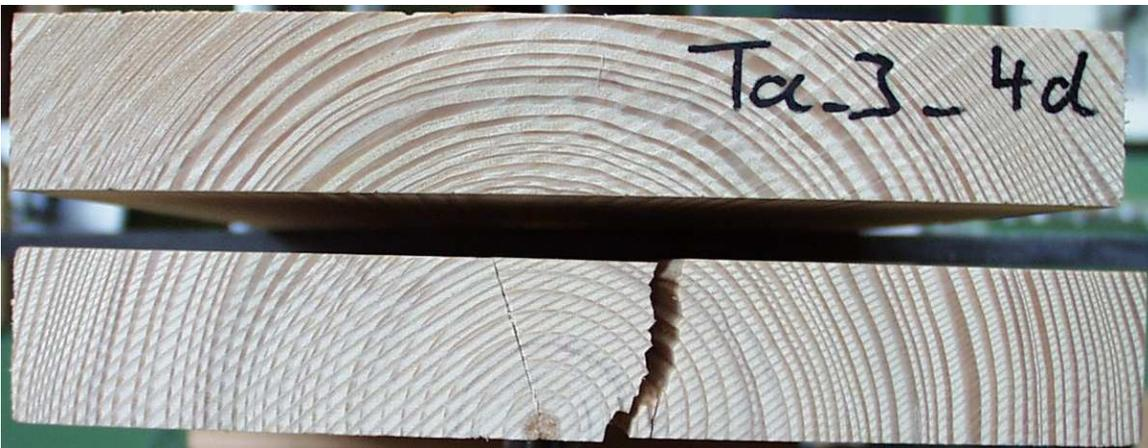
**Bild 6.1.3:** Querschnitte der Seitenlaschen eines Prüfkörpers
